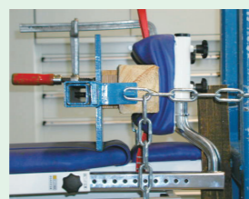
▲機械を使った強度検査の様子
